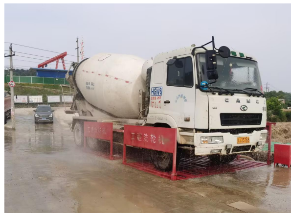
砂石工厂洗车槽
