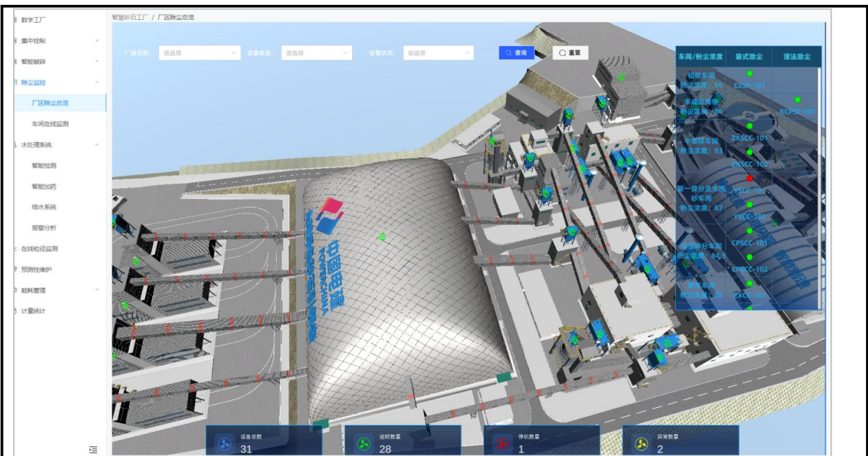
公司智能化除尘设施控制界面
