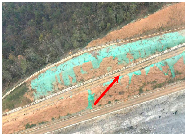
矿区内部排水沟
